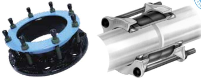
La gamme de raccords FlexLock permet de raccorder et de verrouiller automatiquement lors du serrage des tubes en fonte et en acier à bouts lisses entre eux ou sur un accessoire à bride. Il n'est donc pas nécessaire de réaliser un ancrage de la conduite à l'aide de tirants en acier soudés sur les tubes.
