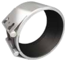
Le raccord autorise une jonction sûre et durable de tous les types de conduites en **PEHD, PVC, fonte ductile, fonte grise, acier noir, acier inoxydable, fibro-ciment, béton et PRV** sans reprise des charges axiales pour une pression de service jusqu'à 25 bar.
