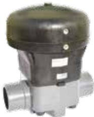
Vanne à membrane pneumatique simple effet normalement fermé, simple effet normalement ouverte ou double effet. Actionneur pneumatique à membrane - Corps en PP-GR. Embouts mâles à coller. Membrane EPDM, FPM ou PTFE.
