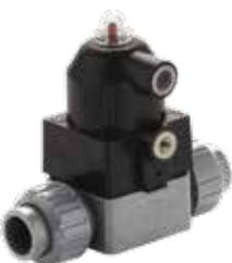
Vanne à membrane pneumatique compacte simple effet. NF ou NO. Embouts mâles à coller ou unions avec embouts femelle à coller. Membrane EPDM (unions : joints toriques EPDM), FPM (FPM) ou PTFE (FPM).
