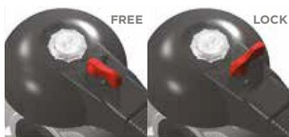
Grâce à la poignée multifonction et au bouton de manœuvre rouge situé sur le levier, il est possible d'effectuer une manœuvre 0°- 90° et une manœuvre graduée au moyen des dix positions intermédiaires et un blocage d'arrêt : la poignée peut être bloquée dans chacune des dix positions tout simplement en agissant sur le bouton de manœuvre Free-Lock. IL EST également possible de cadenasser la poignée pour protéger l'installation contre toute manipulation.
