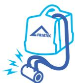
Raccordement par électrosoudage, la solution sans joint ni emboîture pour garantir une résistance aux fuites.
