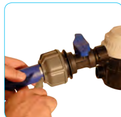
3. Emboîter à fond le tube dans l'embout à compression sans serrer. Repérer la profondeur.
