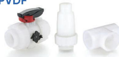
Le polyfluorure de vinylidène est notre thermoplastique le plus technique. Sa résistance chimique est exceptionnelle et des températures de service jusqu'à 140°C sont envisageables, faisant de ce matériau une alternative performante aux coûteux alliages métalliques ou aciers revêtus.
