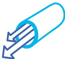
La tuyauterie plastique réduit les pertes de charges dues aux frottements et permet ainsi de réduire la consommation d'énergie des pompes.
