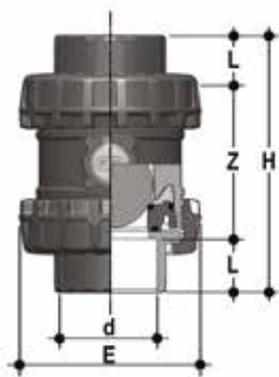
SXEIC Clapet de retenue Easyfit à bille avec embouts femelles à coller, série métrique
