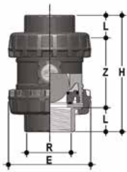
SXENC Clapet de retenue Easyfit à bille avec embouts femelles, taraudage NPT
